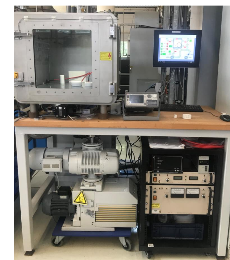
Eigens entwickelte Vorrichtung zur zuverlässigen und reproduzierbaren Messung von Leckströmen/Widerständen an volumen- und oberflächendotierten Isolatoren.
